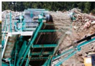
Durch Sortierung und Aufbereitung im Recyclingwerk und kontinuierlicher Qualitätsprüfung werden aus Bauschutt hochwertige Recycling-Baustoffe.
